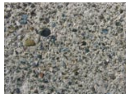
Présence d'éclats de laitier bleu et vert et de roussier.
