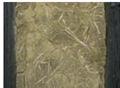
Le mélange d'argile et de débris végétaux requiert trois qualités : plasticité, cohésion et compressibilité
