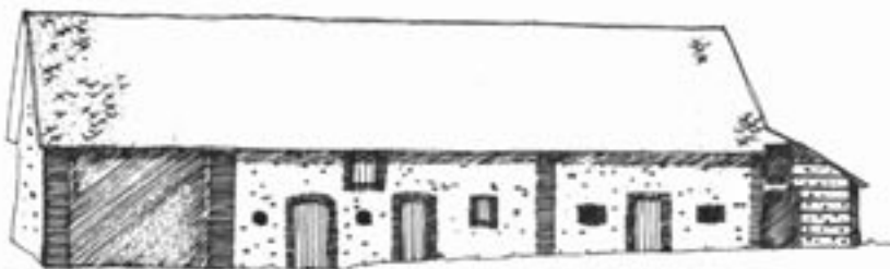
Bâtiment agricole de structure mixte brique et silex.
